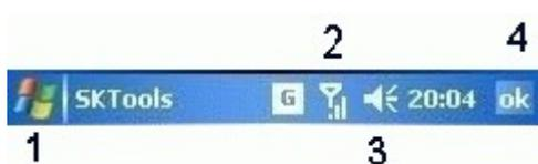
Этот режим включается на вкладке «Standard Taskbar». Режим считается включенным если на вкладке задана хоть одна команда или включена область кнопки закрытия (4). Поддерживаются следующие активные области: (1) кнопка пуск, реагирующая на тап и длинный тап, (2) радио кнопка — реагирует на
